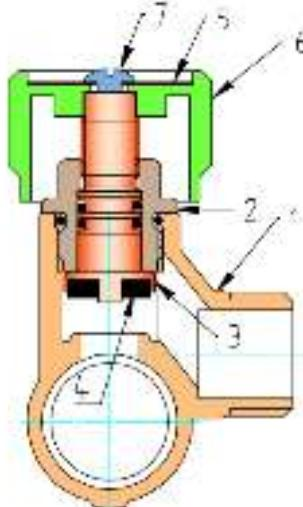
Коллектор состоит из латунного никелированного корпуса 1, имеющего на концах присоединительные резьбы (с одной стороны внутреннюю, с другой наружную) и встроенных в корпус регулирующих клапанов.
